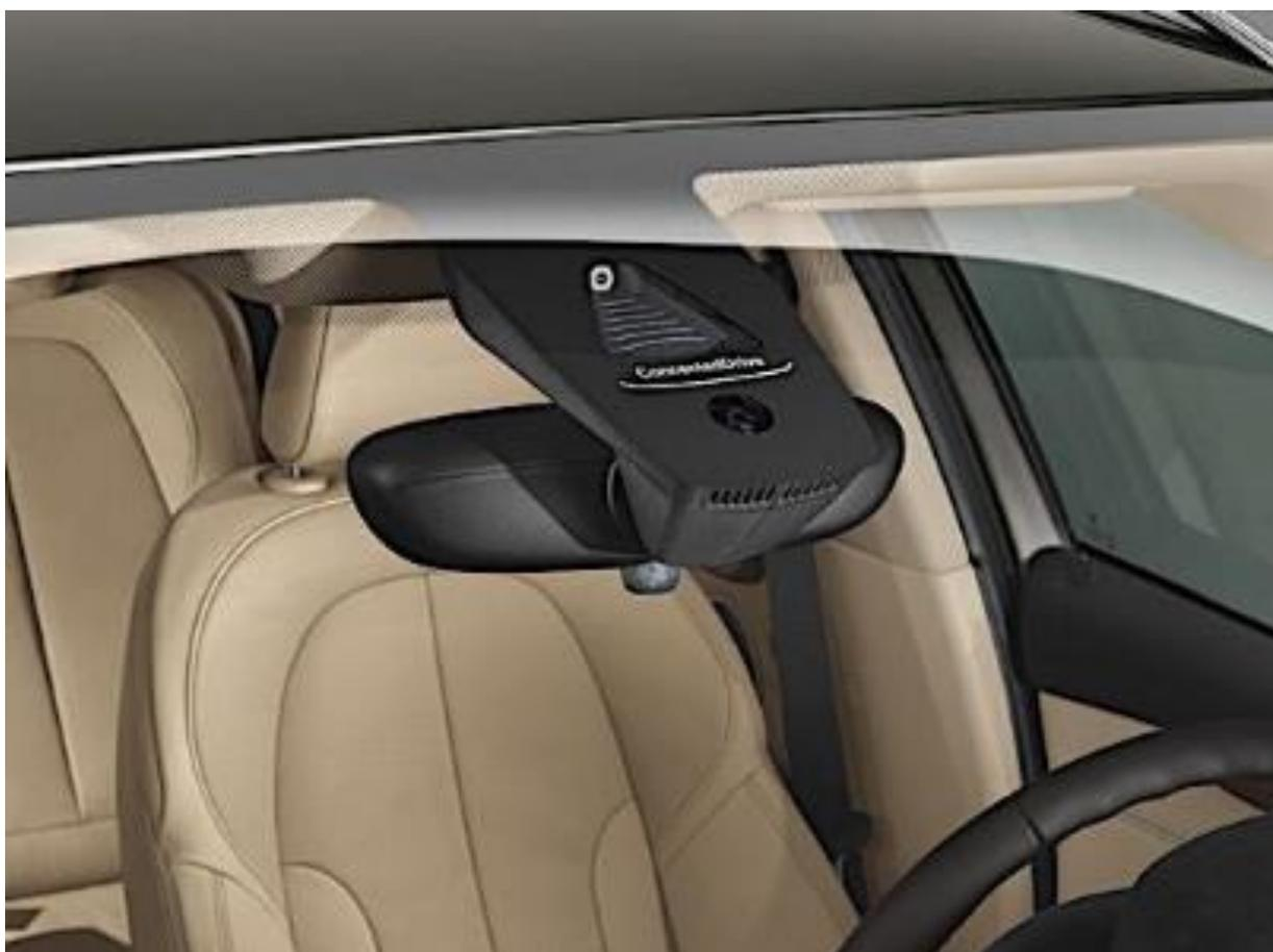
A câmera precisa de calibração após a substituição do para-brisa.
