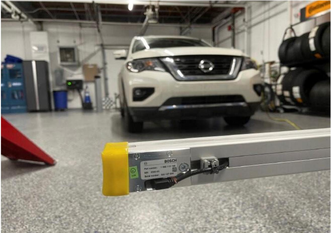
Quando você configura um alvo ou acessório para uma câmera ou radar, a posição e a distância do veículo são críticas para o desempenho e a operação do sistema. Se o alvo ou acessório estiver alguns milímetros afastado quando colocado a poucos metros do sensor, ele pode alterar o alinhamento do sensor em metros quando apontado para a estrada ou a altura do veículo no ponto cego.
