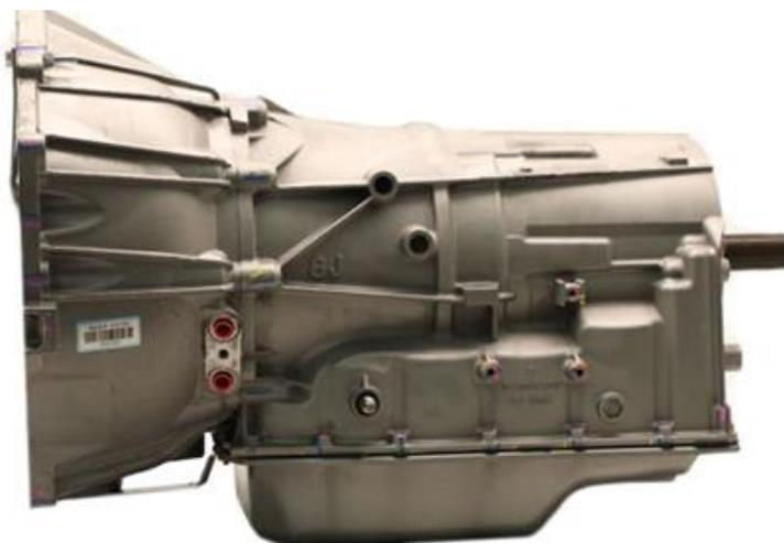
O uso de aplicação da transmissão 6L80 tem sido extenso ao longo dos anos. A General Motors originalmente fabricou esta transmissão. Ele foi projetado para aplicações AWD/4WD e RWD General Motors. O 6L80 possui operações exclusivas, como um controlador avançado de computador embutido no corpo da válvula e uma embreagem direta para troca de embreagem.
