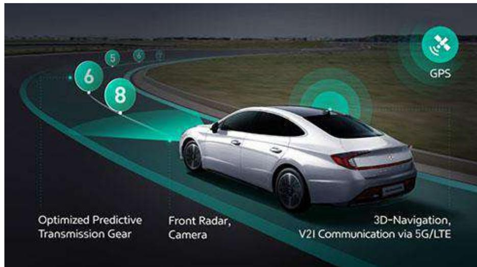
A Hyundai e a Kia dizem que desenvolveram o primeiro sistema de câmbio conectado a tecnologia de informação e comunicação preditiva (TIC) do mundo, permitindo que o veículo mude automaticamente para a marcha ideal depois de identificar as condições da estrada e do tráfego.
