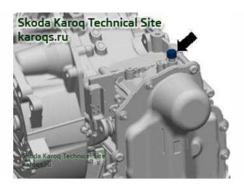
A tampa de ventilação mecatrônica quebra quando removida e deve ser substituída; consulte o catálogo eletrônico de peças de reposição originais.
