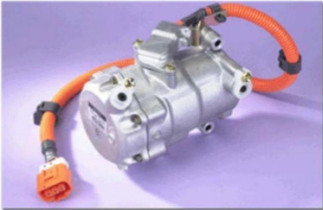
O Prius '04 e posterior usa um compressor elétrico acionado por um motor integrado. O motor funciona com 201,6 V CA fornecido pelo inversor de A / C, de modo que a operação do compressor não depende do motor.
