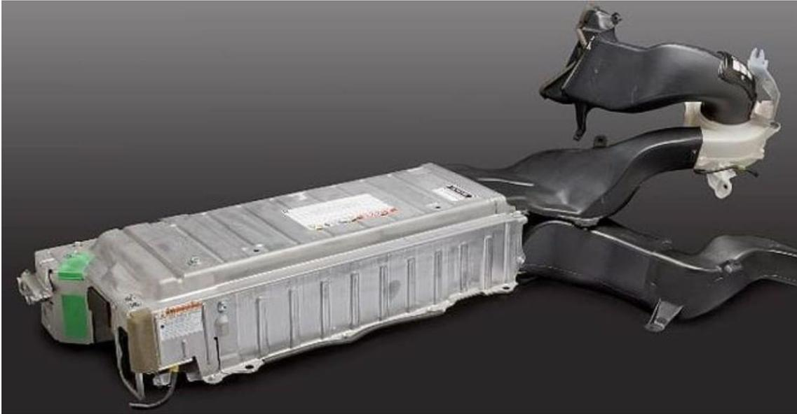
A pilha de baterias Prius consiste em 38 módulos prismáticos NiMH conectados em série. Ele fornece 273,6 Volts nominais e tem uma capacidade de 6,5 Ah.
