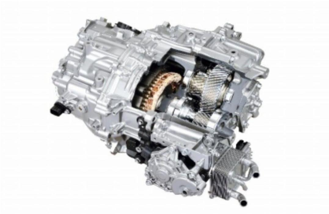
O módulo de acionamento elétrico “eAxle” do Grupo Aisin foi adotado para o LEXUS UX300e, o primeiro veículo elétrico comercial da marca.
