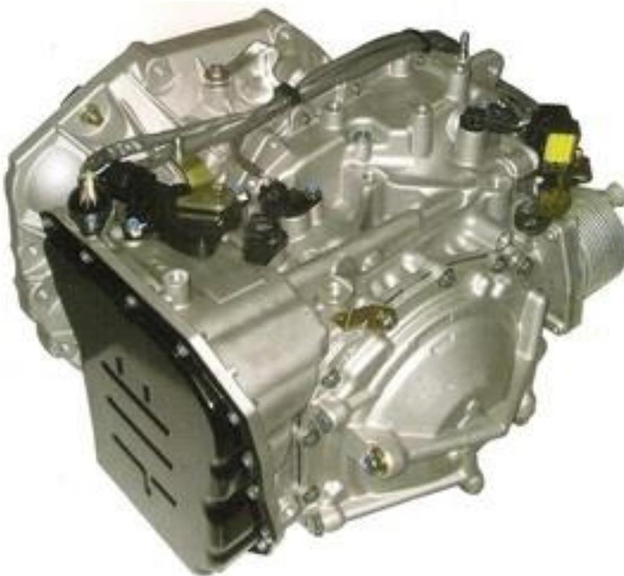
Para verificar a pressão da linha principal, use o bujão da linha de baixa pressão da embreagem localizado próximo do sensor de velocidade de entrada da transmissão, conforme mostra na figura 01. Com o motor na temperatura de operação, aproximadamente entre 70°C e 90°C, a pressão deve medir entre 55 a 76 psi com a alavanca seletora em "D" e motor na marcha lenta. E 222-230 psi no teste de Stall
