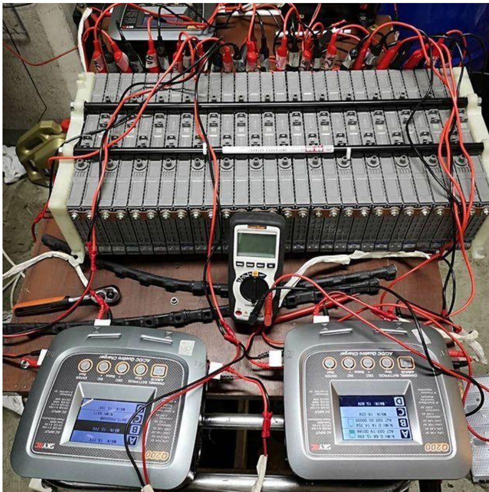
Restaurando uma bateria híbrida do Toyota prius 2010.
